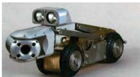
Kamera TV, która dokonuje przeglądu kanałów.
